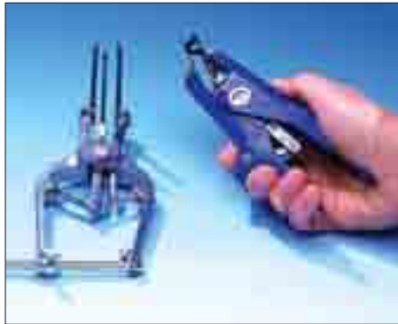
Einfache und sichere Montage von Tüllen und Schläuchen durch Dreidornzangen.
