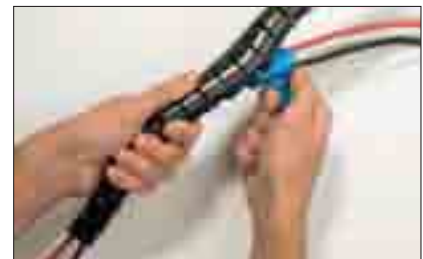
Helawrap wird nun nach dem Reißverschlussprinzip montiert.
