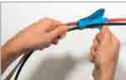
Kabelbündel seitlich in das Aufziehwerkzeug legen.
