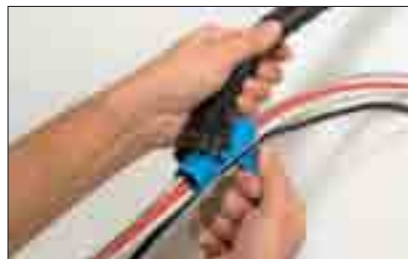
Helawrap auf das Werkzeug aufstecken.
